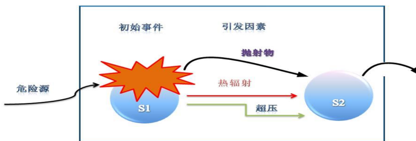
图 3.6-1 多米诺效应系统图
