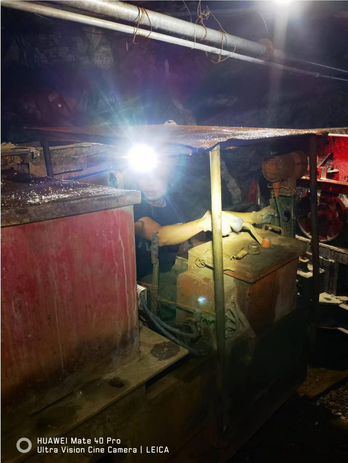
矿山井下平巷运输工具（电瓶机车）
